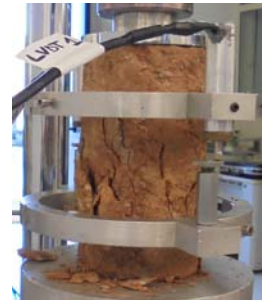
Foto dopo rottura
