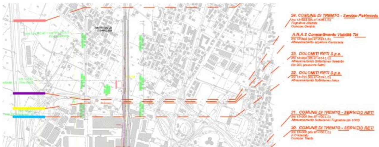
**Caratteristiche del sottoservizio:** Attraversamento sotterraneo di Gasdotto Dn 200 pressione di 5 atm (Alta pressione) terza specie
