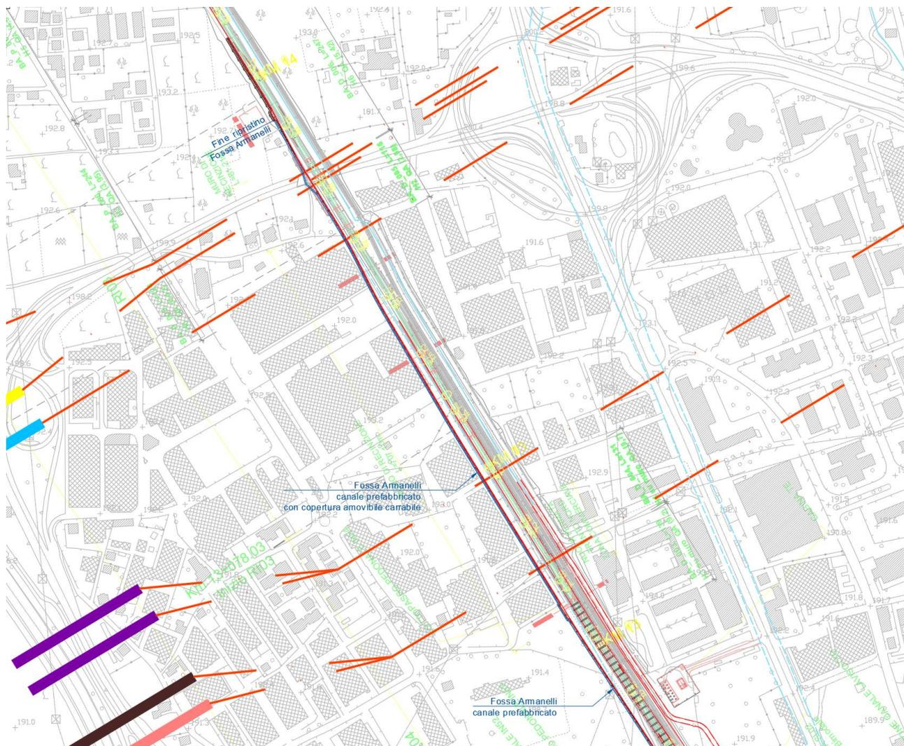
Caratteristiche del sottoservizio: Canale prefabbricato con copertura amovibile carrabile
