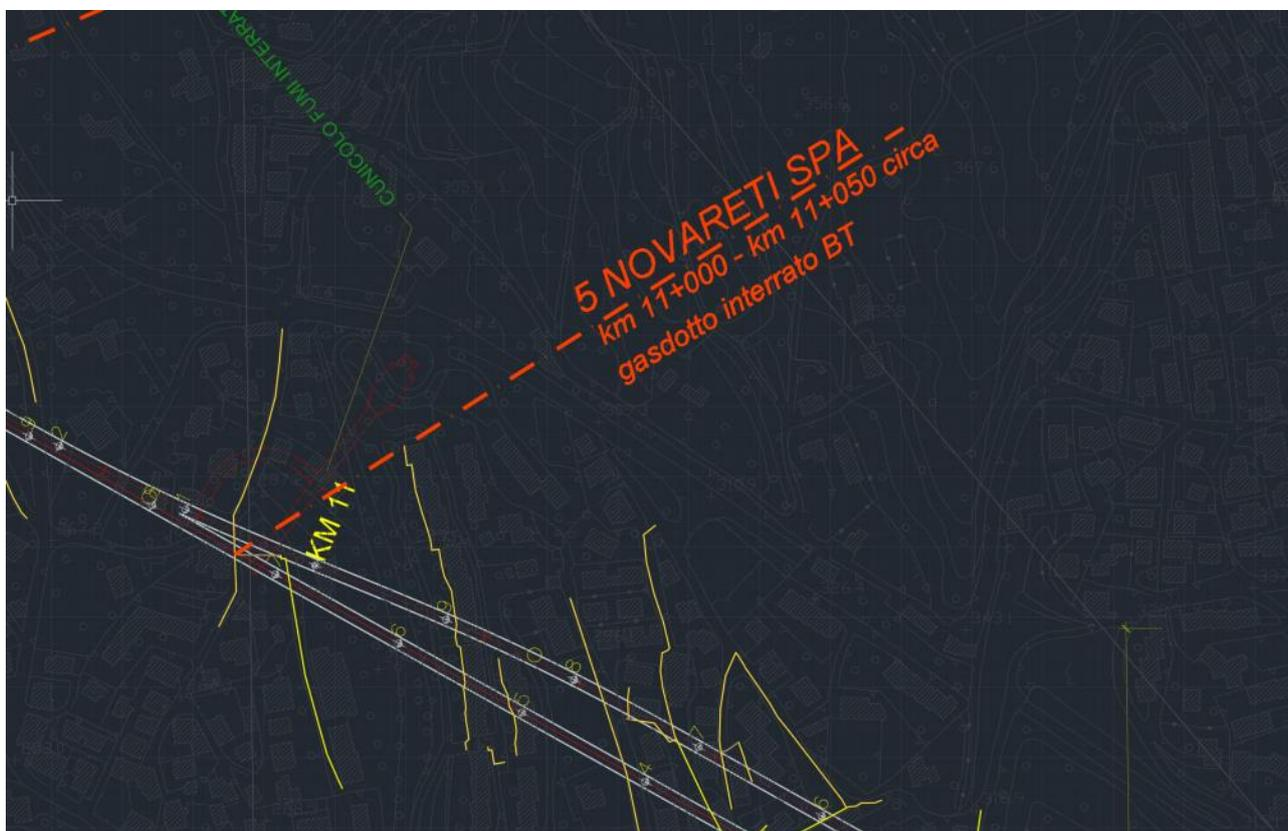
Caratteristiche del sottoservizio: attraversamento gasdotto BP
