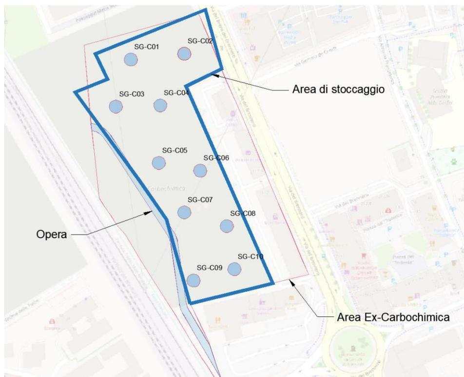
Figura 73- Ubicazione delle sonde di monitoraggio soil gas
