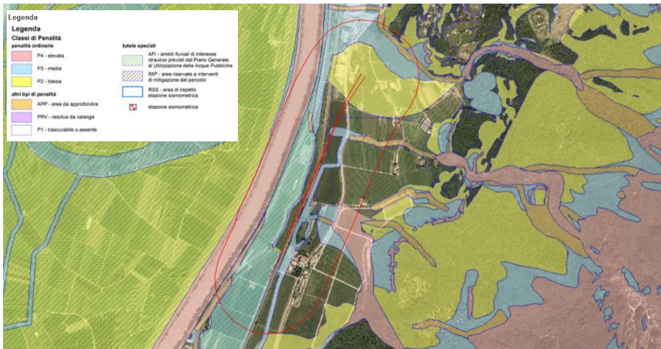
Figura 2-7 Sovrapposizione del tracciato (tratti all'aperto) con la Carta di sintesi della pericolosità (CSP)
