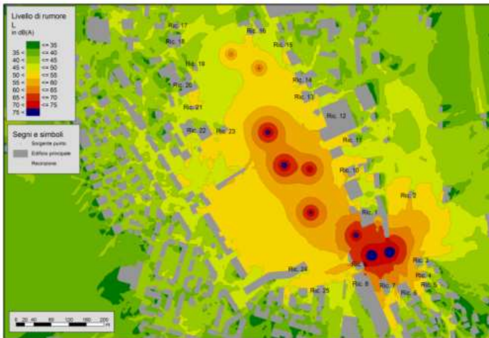
Figura 6-18 Output del modello di simulazione in planimetria per i cantieri CO.02 e AT.01 nel periodo di riferimento notturno
