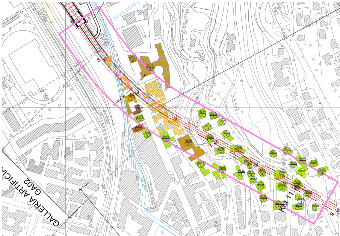
Figura 20 - Bivio Trento Nord. In rosso la fascia di 10 metri nella quale sono contenuti i ricettori per cui si valuta il superamento del limite (8025; 8018; 8016; 8013; 8010; 8006; 8003; 9006; 9009; 9012; 9015)
