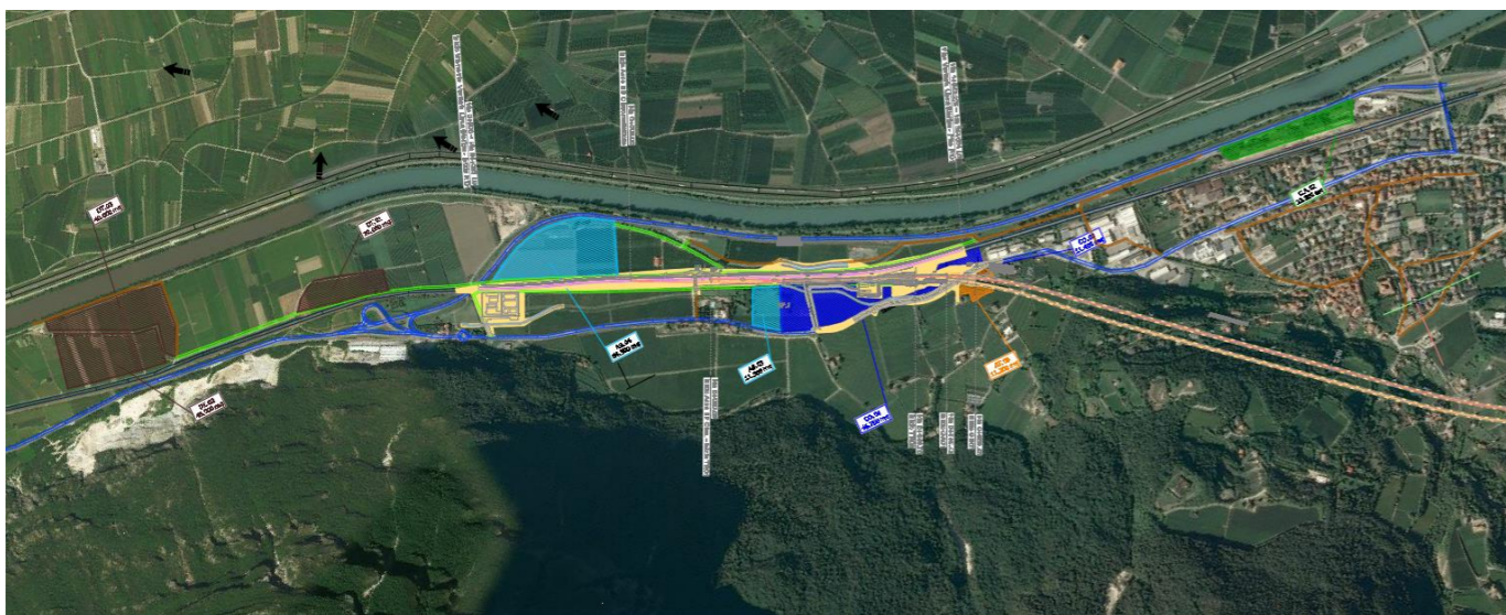
Figura 3-18 Aree cantiere fronte sud Galleria Trento.
