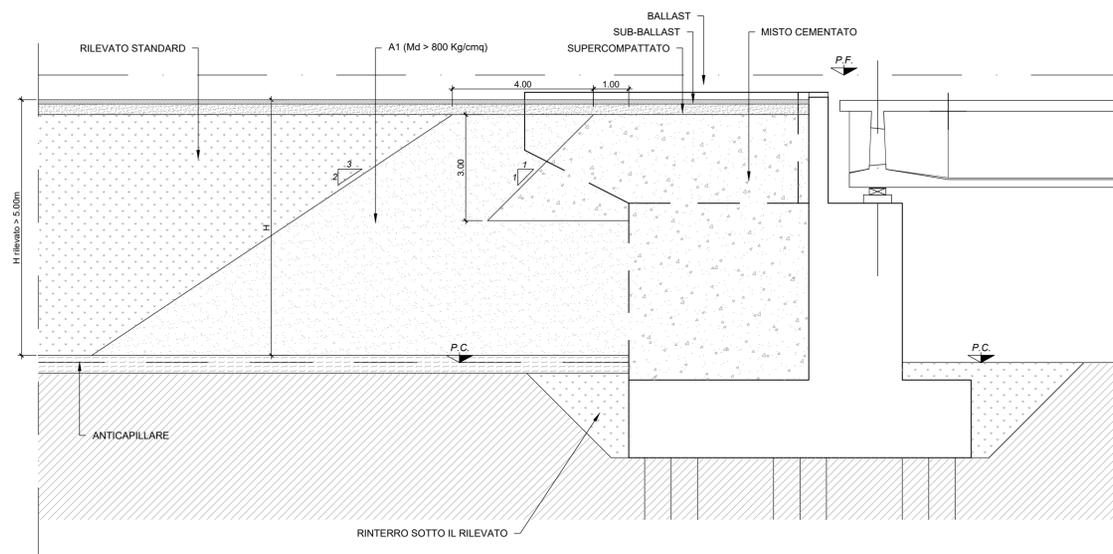
CARATTERISTICHE MATERIALI DA RILEVATO/TRINCEA
