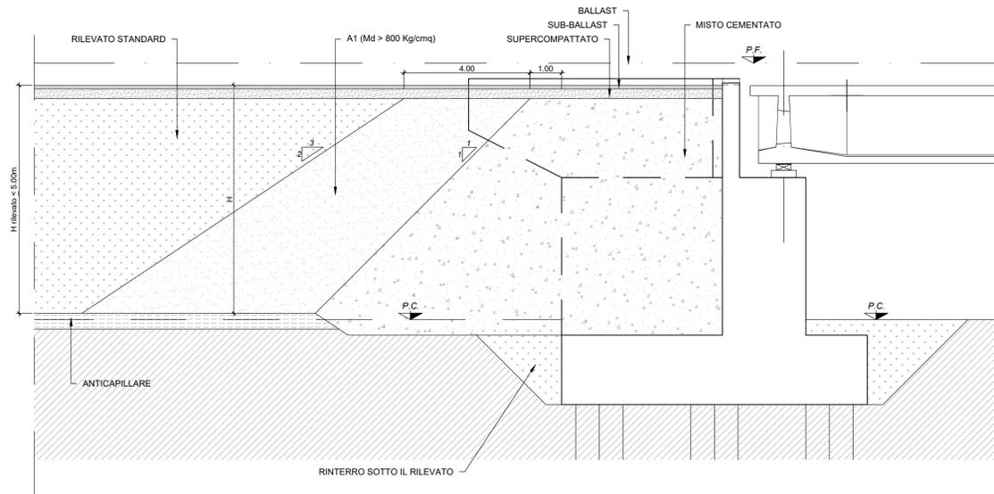
SEZIONE DI TRANSIZIONE RILEVATO-VIADOTTO
