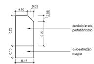
**DETTAGLIO PAVIMENTAZIONE STRADALE TIPO 2 Categoria strada a destinazione particolare 4.00m - 6.50m**
