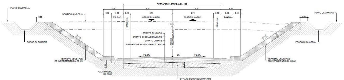
Figure 6-3: Dest. Particolare 6.5m - sezione tipo in trincea
