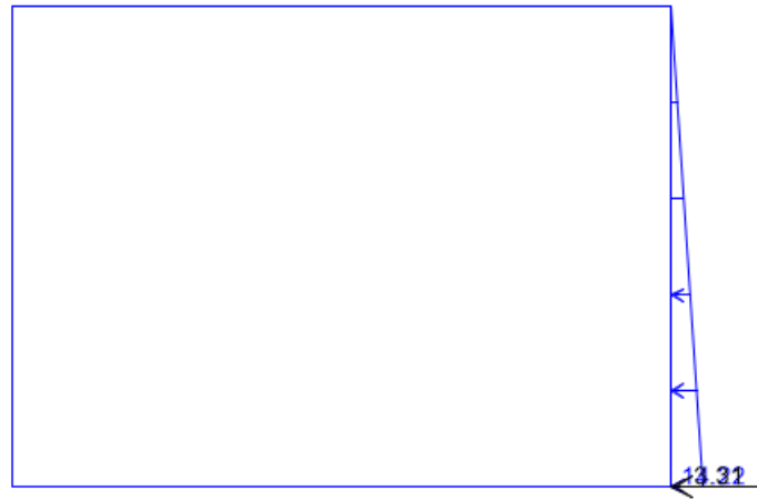
Fig. 5 – Spinta statica del terreno.
