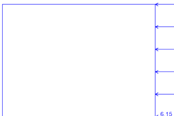
Fig. 7 – Spinta orizzontale del ballast.
