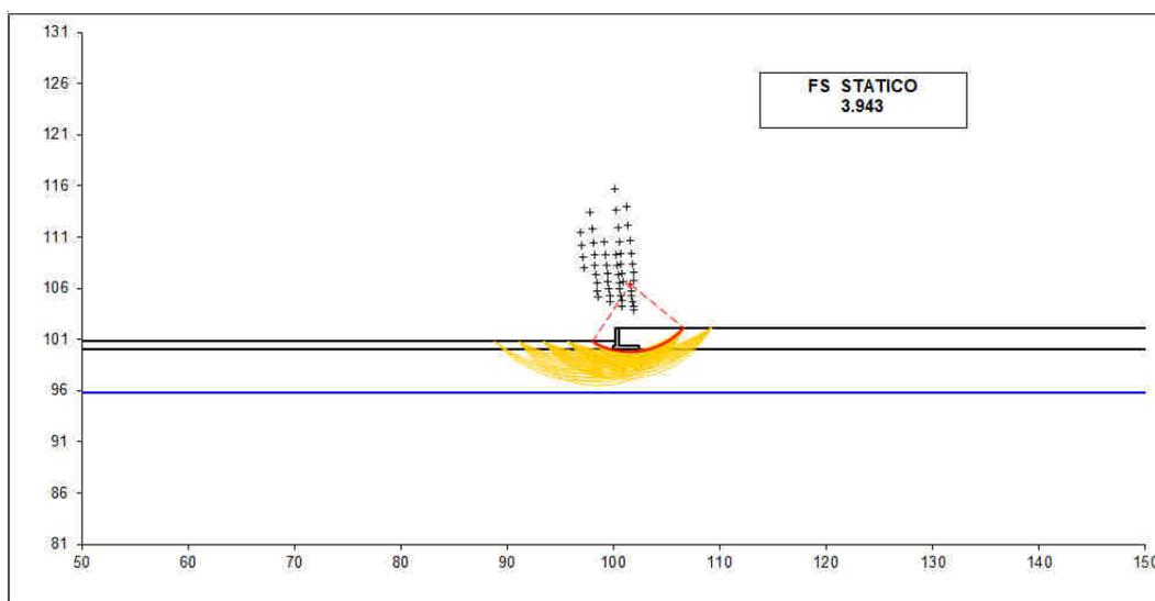
TR01: MURO DI SOSTEGNO MU29
