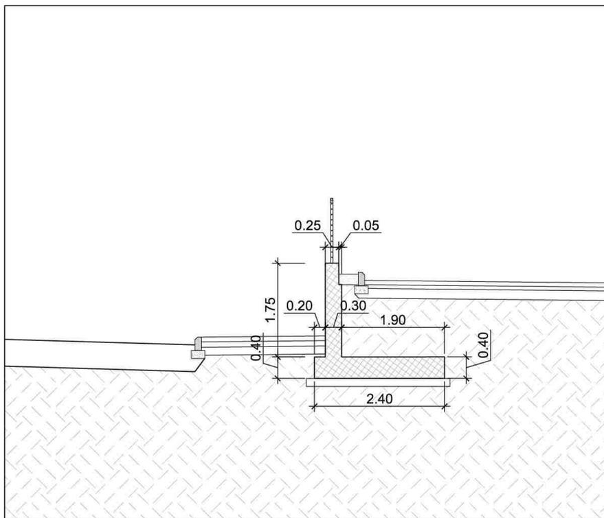
*Figura 1-3 – TR01: Muro di sostegno MU29– Sezione trasversale*
