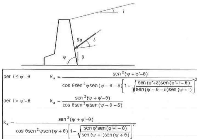
Figura 8-2 – Coefficiente di spinta attiva e passiva.
