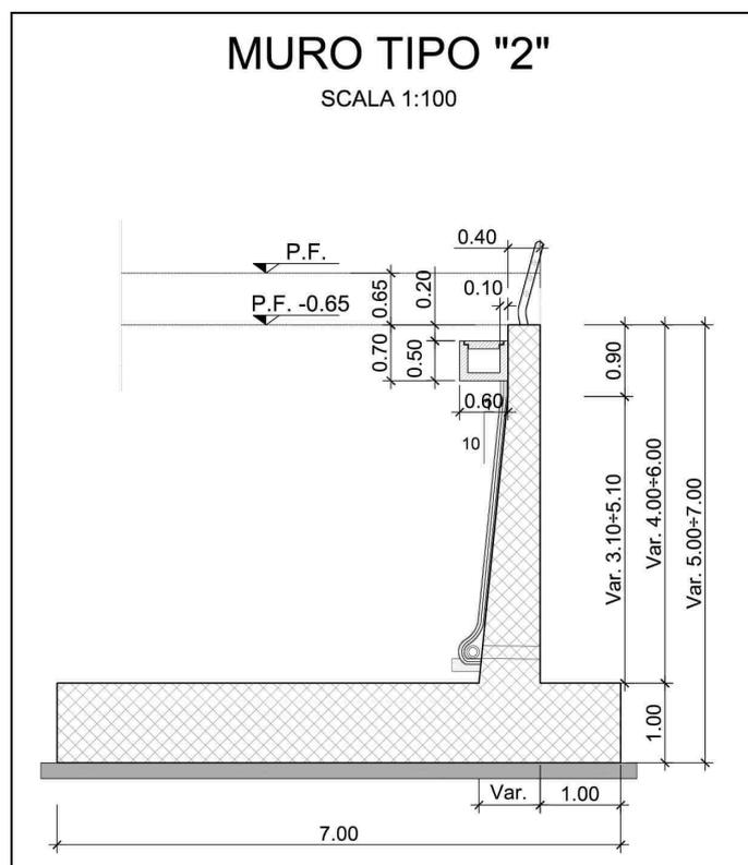
Figura 1-5 – RI53 – TR52: Paratia di sostegno in dx MU54 - Sezione trasversale muro tipo 2.
