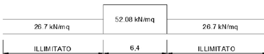
Considerando la ripartizione dei carichi attraverso il sottostante rilevato fino alla quota della testa dell'opera di sostegno con un angolo pari all'angolo di attrito interno del terreno ( $38^\circ$ ) si ottiene un carico in corrispondenza del piano orizzontale alla quota della testa dell'opera di sostegno pari a:
