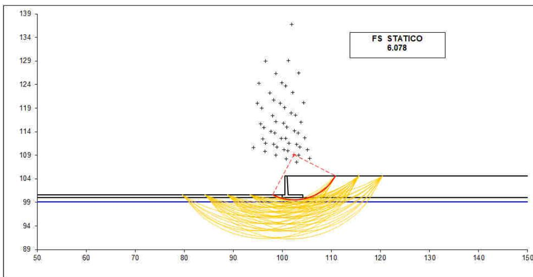
RI53 - TR52: MURO DI SOSTEGNO IN DX MU54
