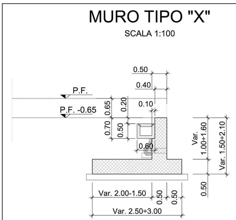
Figura 1-3 – RI53 – TR52: Paratia di sostegno in dx MU54 - Sezione trasversale muro tipo x.
