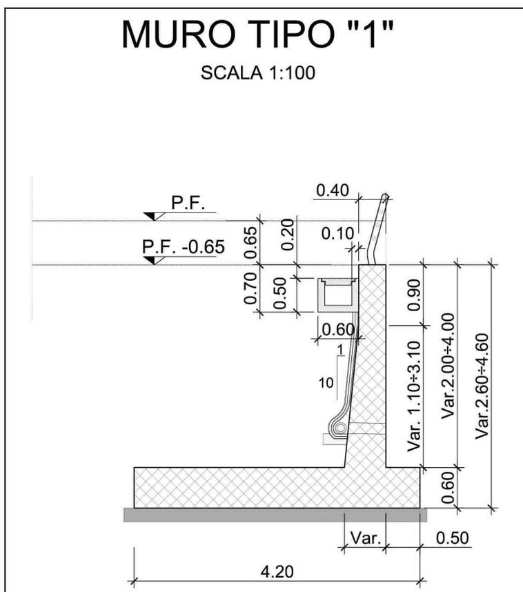
Figura 1-4 – RI53 – TR52: Paratia di sostegno in dx MU54 - Sezione trasversale muro tipo 1.
