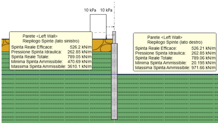
Figura 18. Spinte in corrispondenza dell'altezza massima di scavo
