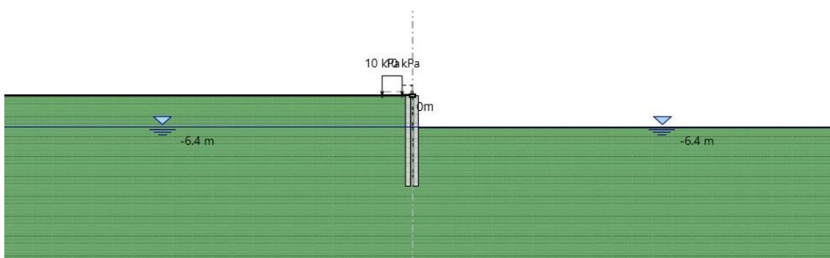
Figura 3. Schema di calcolo paratia – fondo scavo
