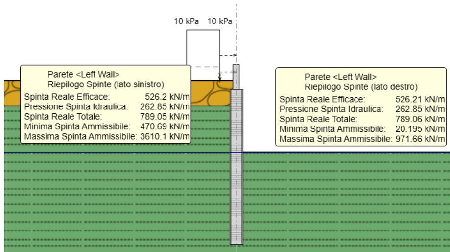
Figura 18. Spinte in corrispondenza dell'altezza massima di scavo
