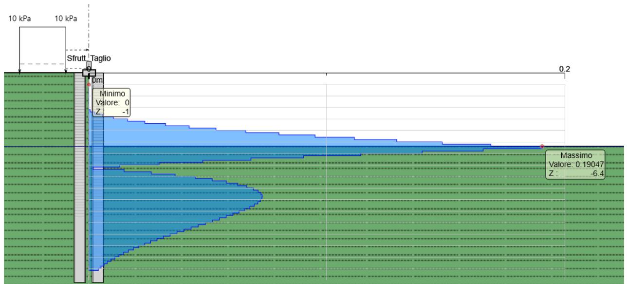
Figura 8. Coefficiente di sfruttamento del taglio
