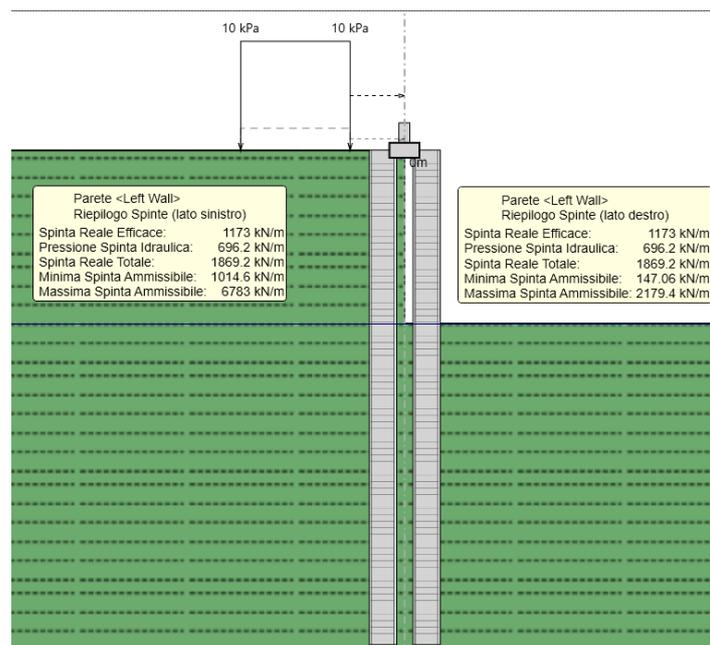
Figura 9. Spinte in corrispondenza dell'altezza massima di scavo
