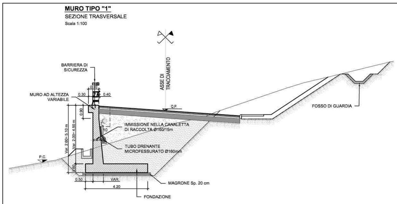
Figura 1-3 – NV05A: Muro di sostegno MU16 - Sezione.
