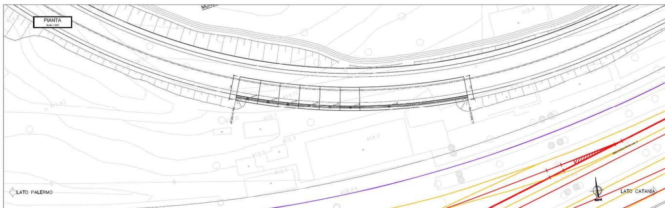
Figura 1-1 – NV05A: Muro di sostegno MU16 - Pianta.
