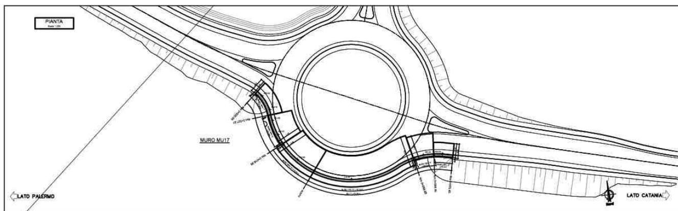
Figura 1-1 – NV05D: Muro di sostegno MU17 - Pianta.
