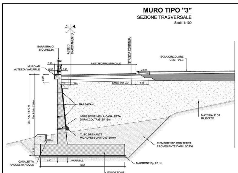
Figura 1-5 – NV05D: Muro di sostegno MU17- Sezione "tipo 3".
