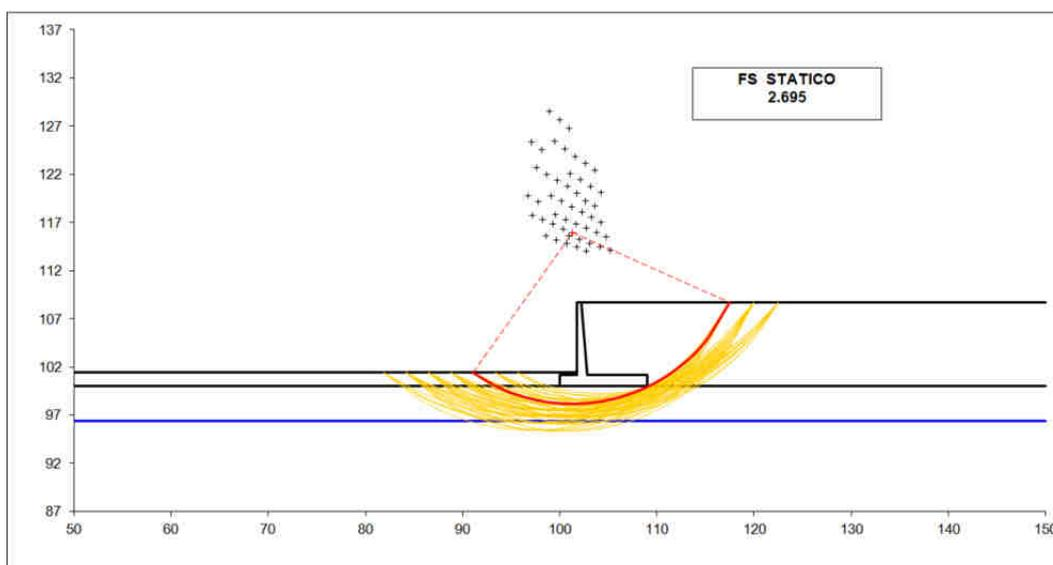
NV05D: MURO DI SOSTEGNO MU17
