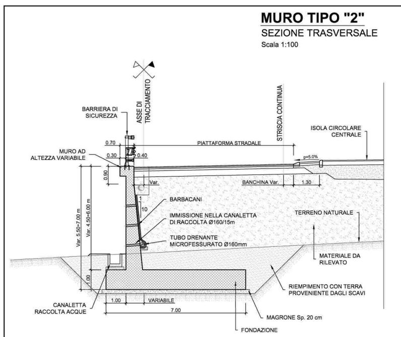
Figura 1-4 – NV05D: Muro di sostegno MU17- Sezione "tipo 2".
