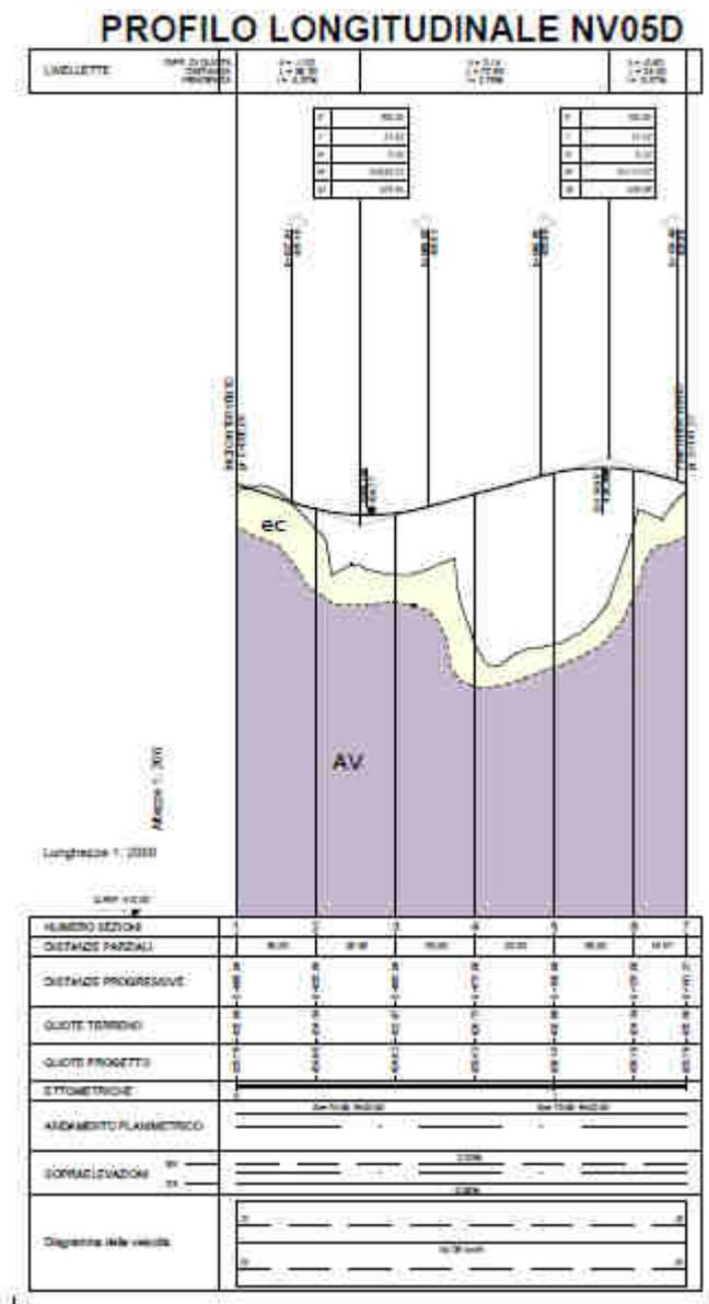
Figura 6-1 – Stralcio del profilo geotecnico.
