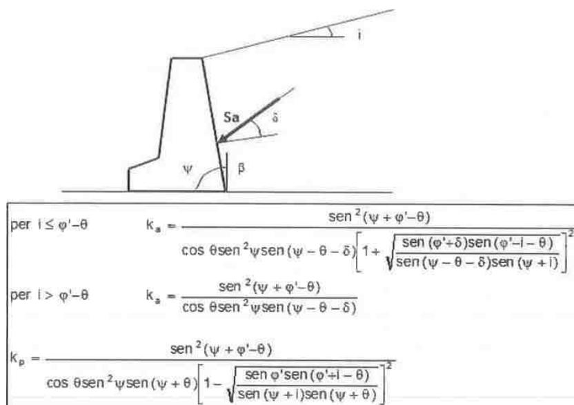
Figura 8-4 – Coefficiente di spinta attiva e passiva.
