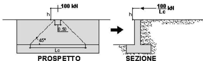
Figura 8-7 – Schema di diffusione della forza di collisione.
