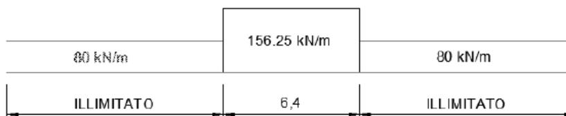
Considerando che la distribuzione trasversale dei carichi è su una larghezza massima di  $3 \text{ m}$  secondo quanto previsto da EN 1991 – 2:2003/AC:2010, si utilizza una larghezza di progetto pari a  $2,40 \text{ m}$  in quanto risulta cautelativo rispetto a quanto previsto dalla norma sopra citata. Si ricava, quindi, il carico equivalente unitario agente alla quota della piattaforma ferroviaria:
