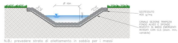
SEZIONE TIPO CAMBIO SEZIONE
