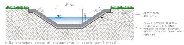
SEZIONE TIPO CAMBIO SEZIONE
