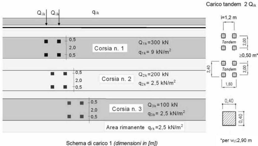
Figura 7 – Schema di Carico 1 del D.M. 17/01/2018
