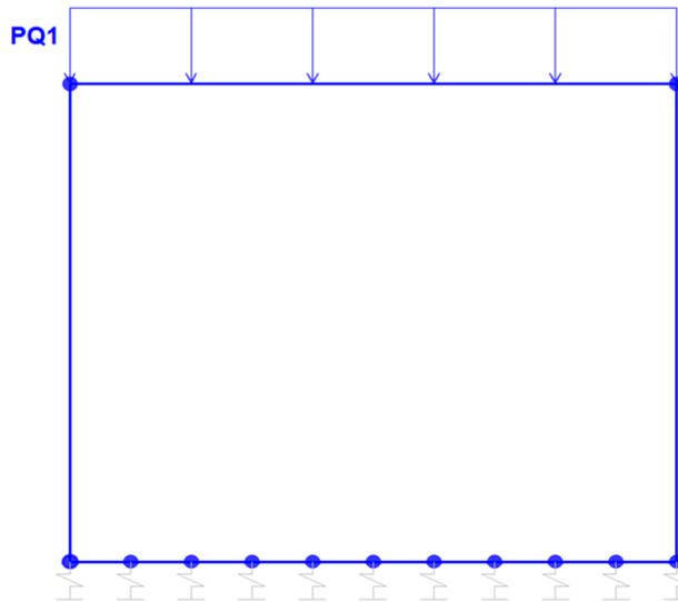
Figura 9. Condizione di carico ACCM da SAP2000
