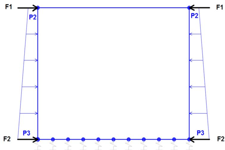
Figura 6. Condizione di carico SPTDX-SPTSX da SAP2000
