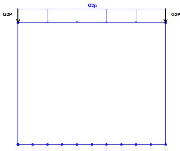
Figura 5. Condizione di carico PERM da SAP2000
