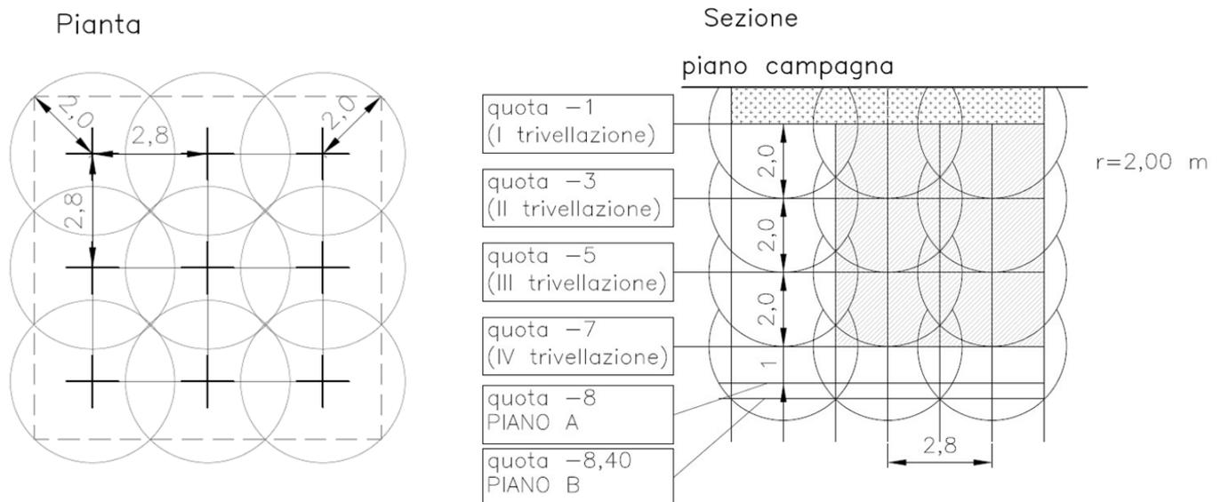
L'equidistanza tra le perforazioni è di 2.80 mt, mentre il raggio di efficacia è di 2.00 mt. Le sovrapposizioni che ne risultano sono inevitabili per ottenere la totale copertura della superficie da bonificare.
