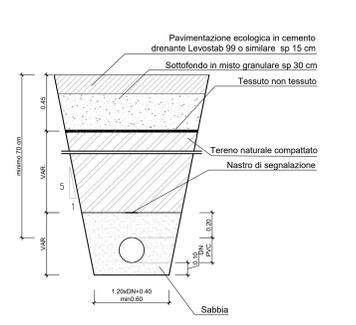
SEZIONE TIPO DI SCAVO E POSA POZZETTO PREFABBRICATO
