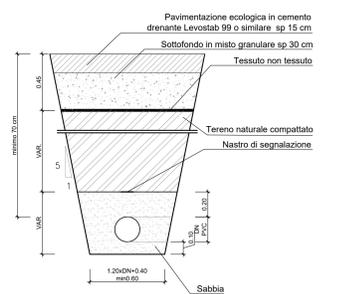
SEZIONE TIPO DI SCAVO E POSA POZZETTO PREFABBRICATO
