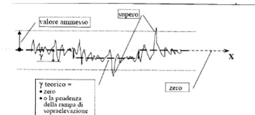
n.b. : il valore ammesso si applica rispetto allo zero, lo sghembo effettivo è comprensivo della pendenza dell'eventuale rampa di sopraelevazione.
