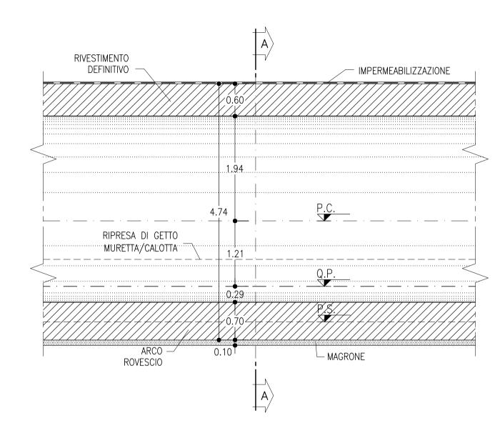
SEZIONE A-A SCALA 1:50 GALLERIA ARTIFICIALE CARPENTERIA RIVESTIMENTO DEFINITIVO - IMPERMEABILIZZAZIONE 2.50 24.87 - 22.03 RIPRESA DI GETTO 4.31 0.82 MURETTA/CALOTTA 0.69 0.74 ARCO ROVESCIO 0.74 ☐ MAGRONE PARTICOLARE "A" 0.90
