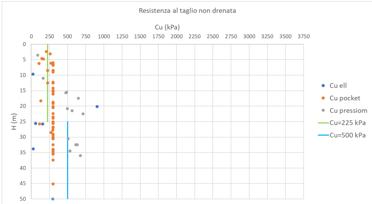
Figura 16: Galleria Trinacria - TRV – coesione non drenata Da 0 – 50 m
