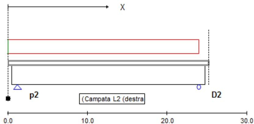
Figura 5-12 - Treno di carico SW2: massimizzazione carico verticale sulla spalla
