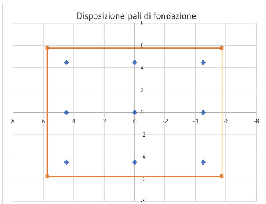
Figura 5-29 - disposizione dei pali di fondazione
