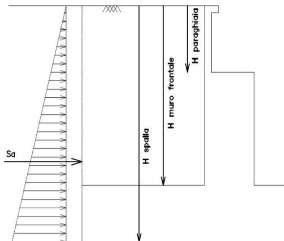
Figura 5-13: schema per il calcolo degli effetti della spinta dovuta al terreno di rinterro
