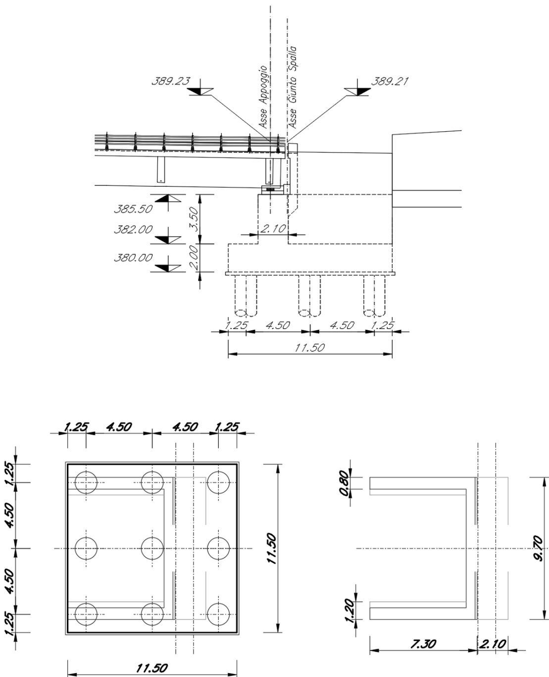
Figura 1-4 - elaborati grafici spalla B (mobile)
