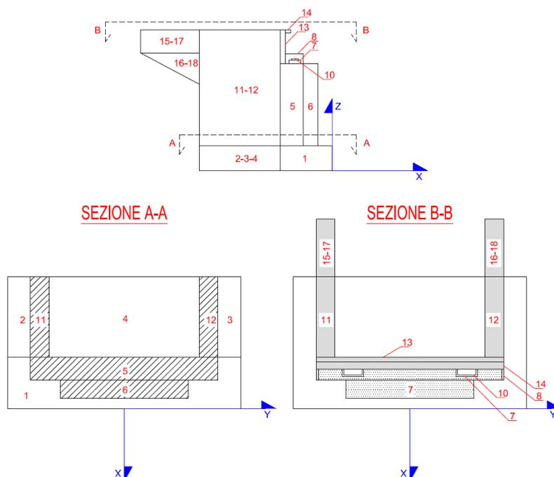
Figura 5-4: Schema qualitativo della geometria della spalla
