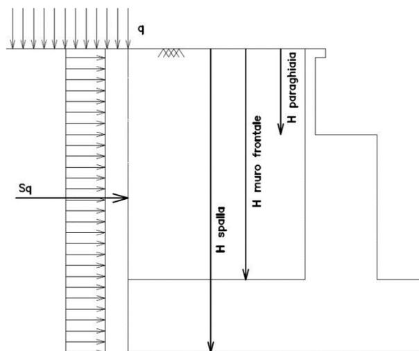
Figura 5-17: Schema per il calcolo degli effetti della spinta dovuta al sovraccarico accidentale
