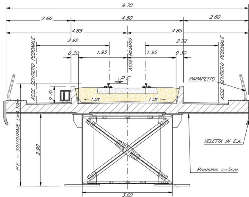
Figura 1-3 - sezione trasversale impalcato tipo in acciaio 40m singolo binario
