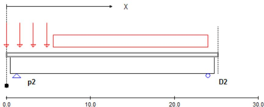
Figura 5-11 - Treno di carico LM 71: massimizzazione carico verticale sulla spalla
