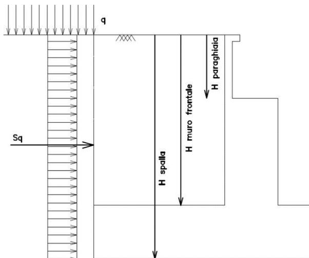
Figura 5-15: Schema per il calcolo degli effetti della spinta dovuta al sovraccarico accidentale
