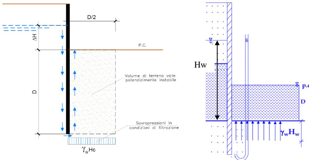
Figura 18: Schema di filtrazione per effetto di scavi sotto falda a valle di opere di sostegno
