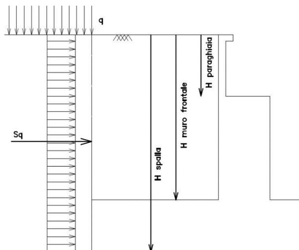
Figura 4-13: Schema per il calcolo degli effetti della spinta dovuta al sovraccarico accidentale
