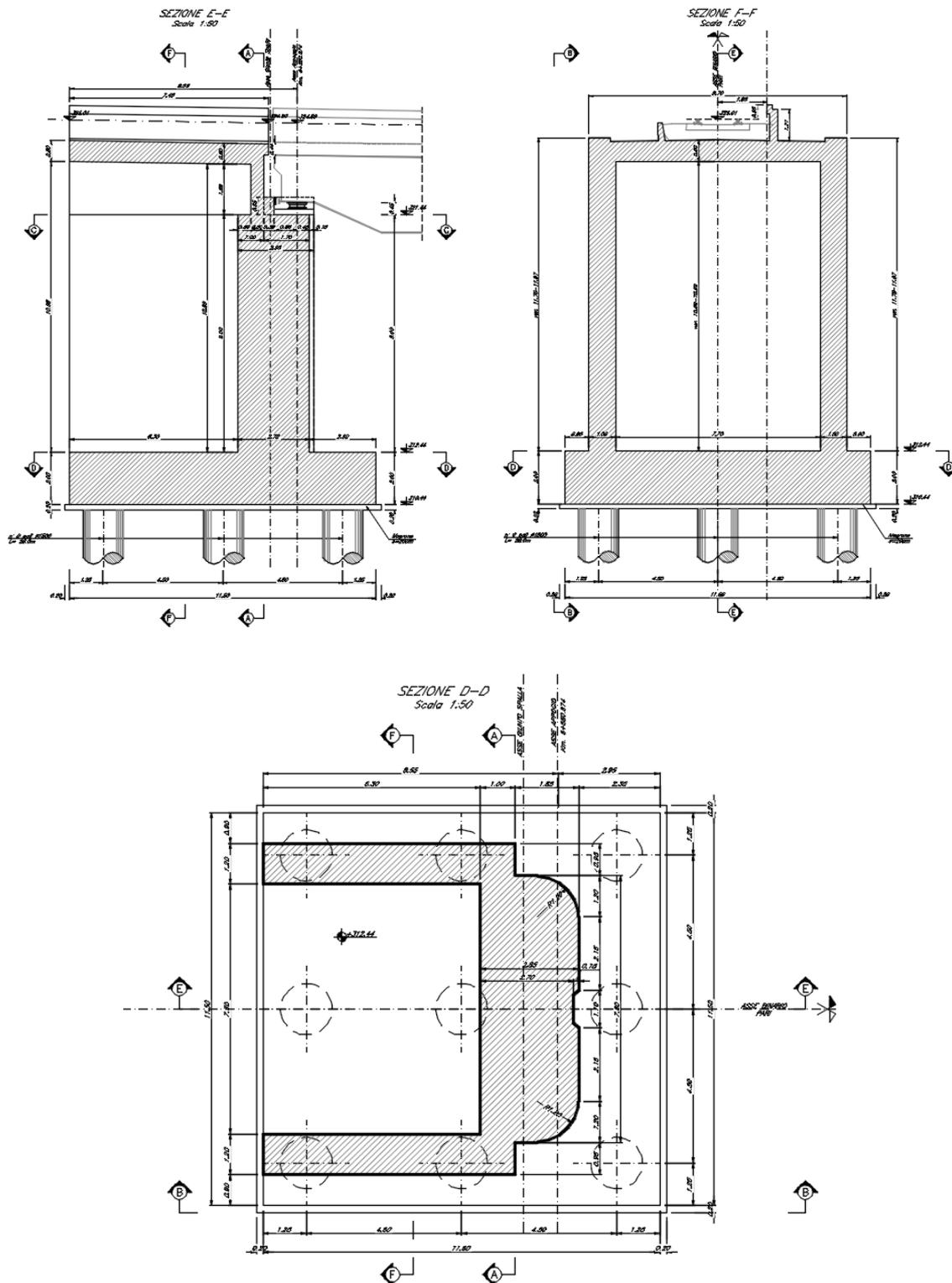
Figura 1-5: elaborati grafici spalla A (mobile)
