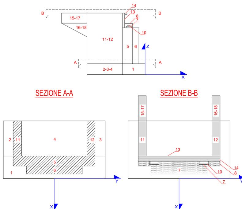
Figura 4-4: Schema qualitativo della geometria della spalla
