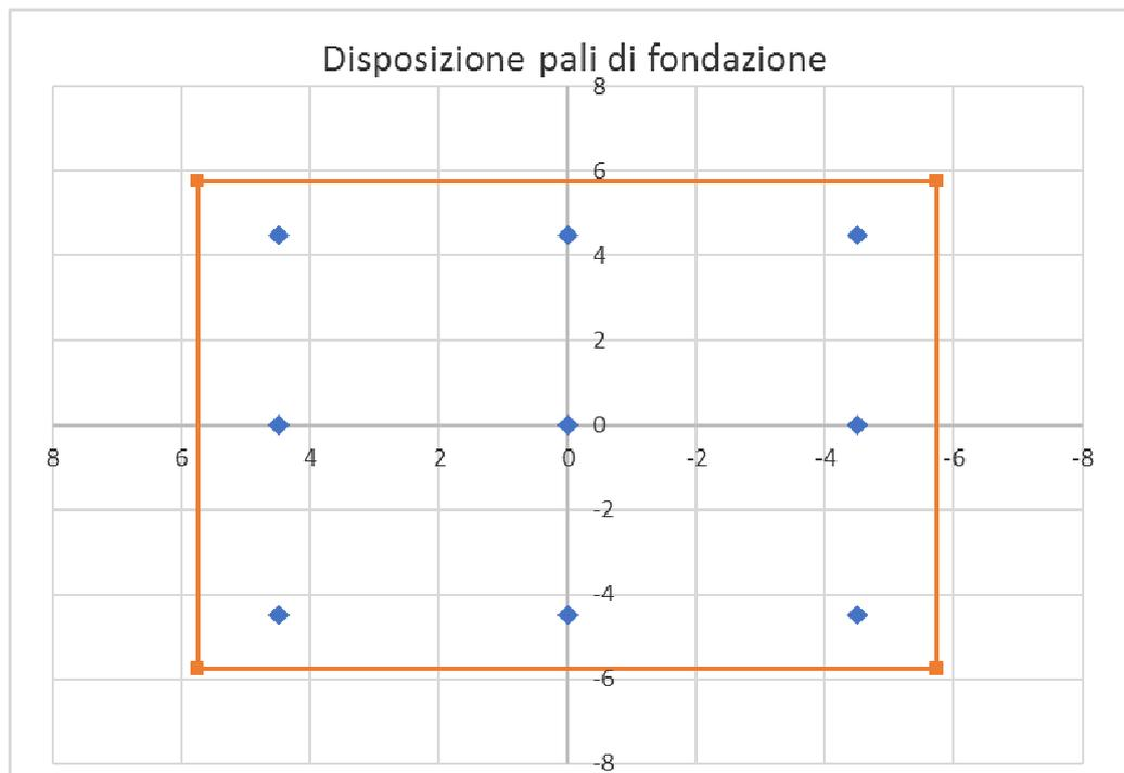
Figura 4-25 - disposizione dei pali di fondazione
