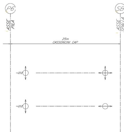
**Figura 1-1-1: schema appoggi**
