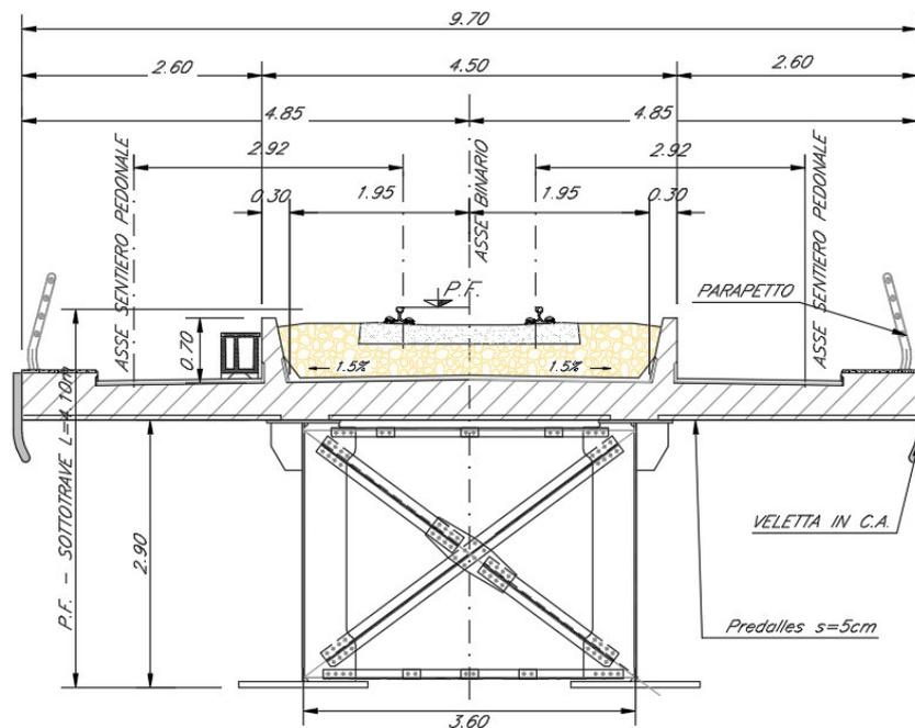
Figura 1-4 - sezione trasversale impalcato tipo in acciaio 40m singolo binario
