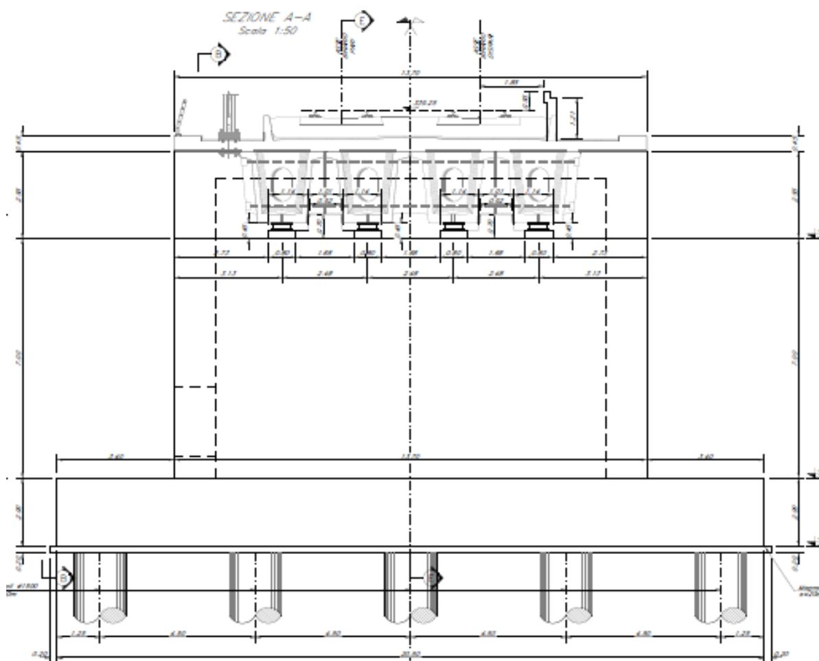
Figura 4-25 - Dettaglio sezione trasversale spalla A
