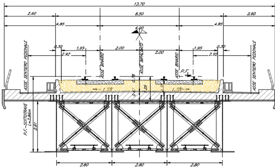
Figura 1-3 - sezione trasversale impalcato tipo in acciaio 40m doppio binario
