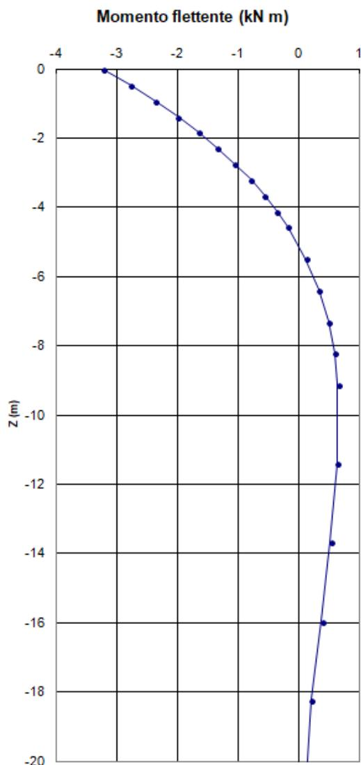
Per le palificate in presenza di scalzamento, il valore del parametro  $\alpha_m$  ( $= M_o/T_o$  a testa palo), è stato valutato considerando non reagente il terreno sino alla profondità di scalzamento. Il valore del parametro indicato per lo scalzamento va associato alle sole condizioni di carico statiche con scalzamento, per tutte le altre combinazioni (SLU statica, SLV sismica e SLE) va associato il valore del parametro indicato per i pali in assenza di scalzamento.
