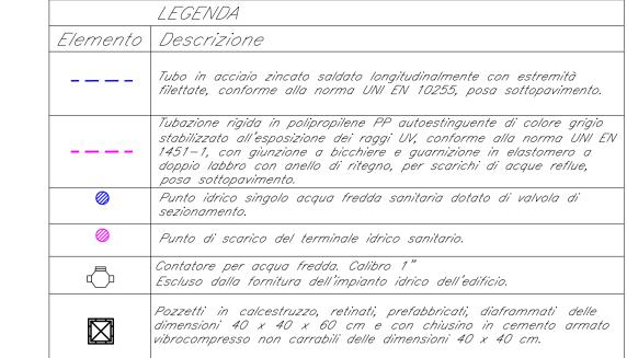
NOTE: • Gli allacci idrici ai singoli apparecchi sono tutti DN 20 o  $\frac{3}{4}$ " (Adduzione idrica)
