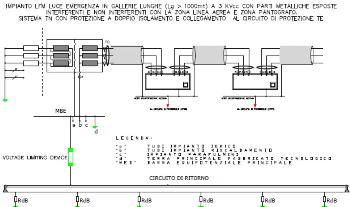
Per un corretto dimensionamento del livello di isolamento di una apparecchiatura in Classe II, è da tenere presente che l'art. 4.1 della norma CEI 11-1 e l'art. 442 della norma CEI 64-8 prescrivono che in generale il livello dell'isolamento principale deve essere correlato alla tensione massima permanente del sistema elettrico.
