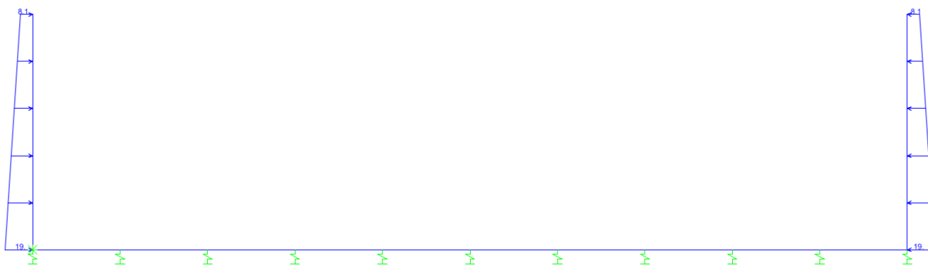
Figura 7.3: spinta del terreno.
