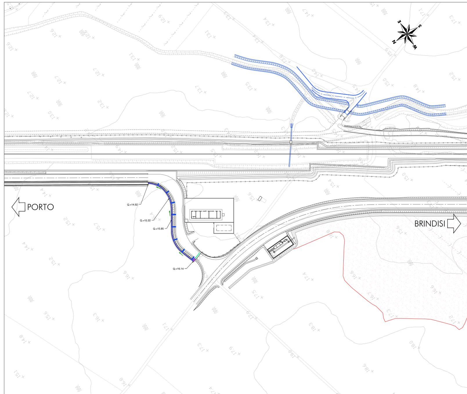
**NOTA BENE:** Nella parte di viabilità, a partire dal tratto in cui la stessa si sviluppa parallelamente alla ferrovia, lo smaltimento idraulico della piattaforma stradale è assicurato dalla presenza di una canaletta per un primo tratto e successivamente di un fosso trapezoidale ubicato tra ferrovia e strada, rappresentati nelle planimetrie di smaltimento idraulico della linea
