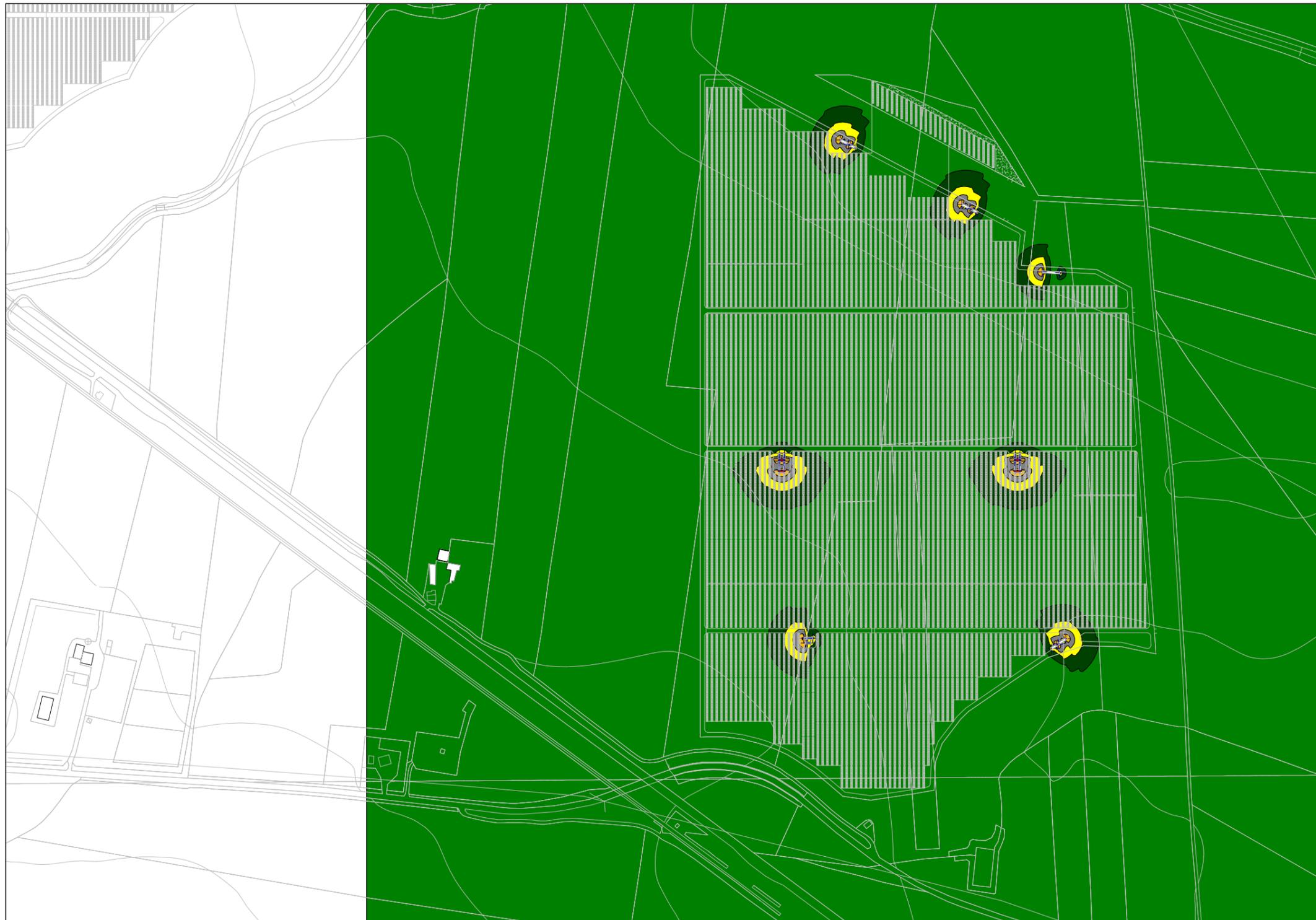
**MAPPA A COLORI CON ISOFONICHE - LIVELLI DI IMMISSIONE NOTTURNI - CAMPO FOTOVOLTAICO OVEST**
