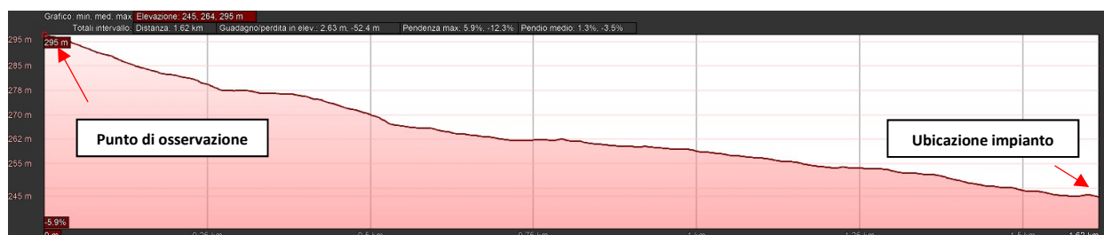
Profilo altimetrico sulla linea di visuale da Masseria Masseriola – IMPIANTO PARZIALEMTNE VISIBILE
