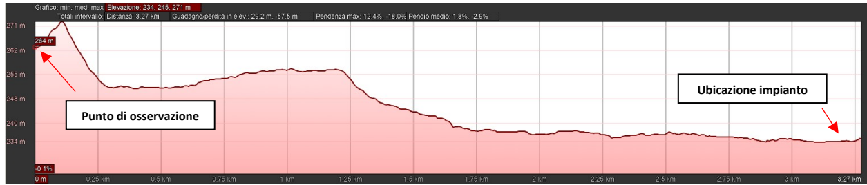
Profilo altimetrico sulla linea di visuale verso Masseria Romano – IMPIANTO NON VISIBILE
