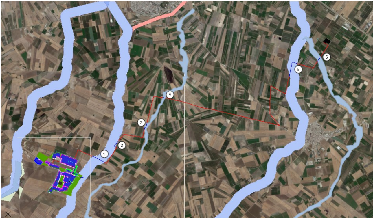
Figura 13: Planimetria delle intersezioni del tracciato del cavidotto con il reticolo idrografico
