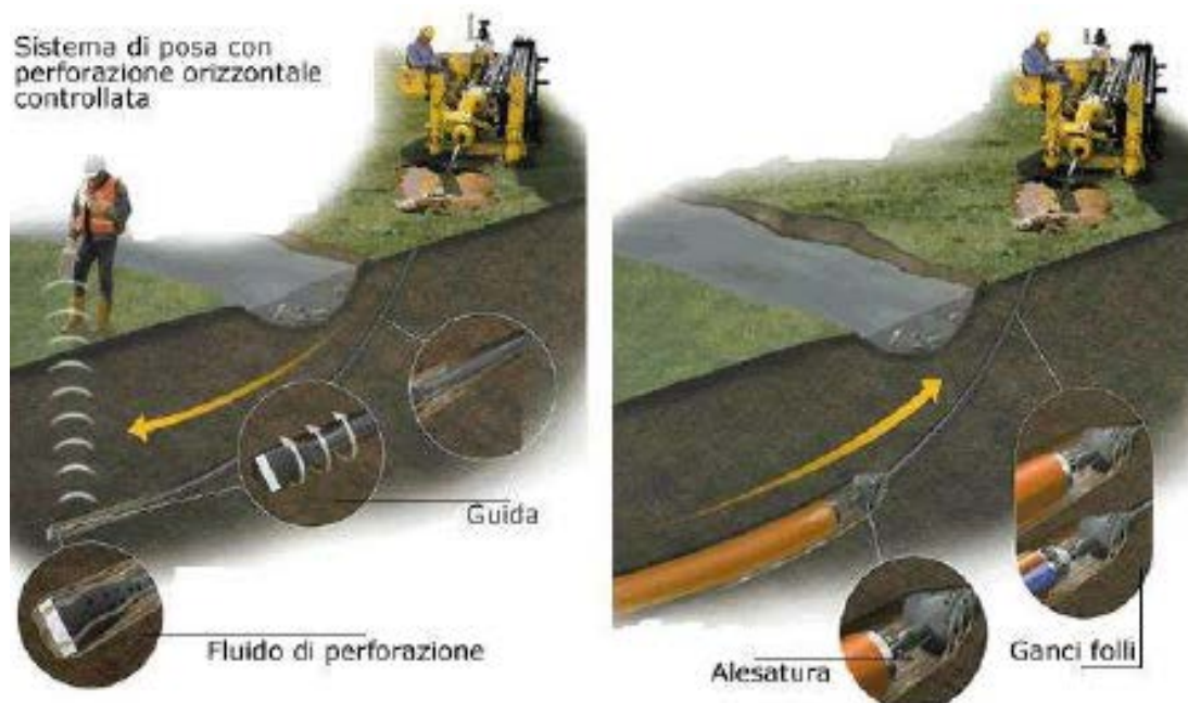
Posa in opera tubazione con trivellazione teleguidata
