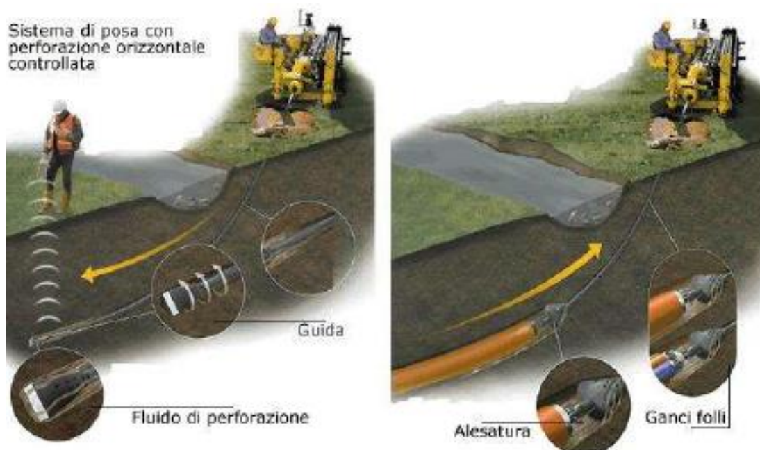
Posa in opera tubazione con trivellazione teleguidata
