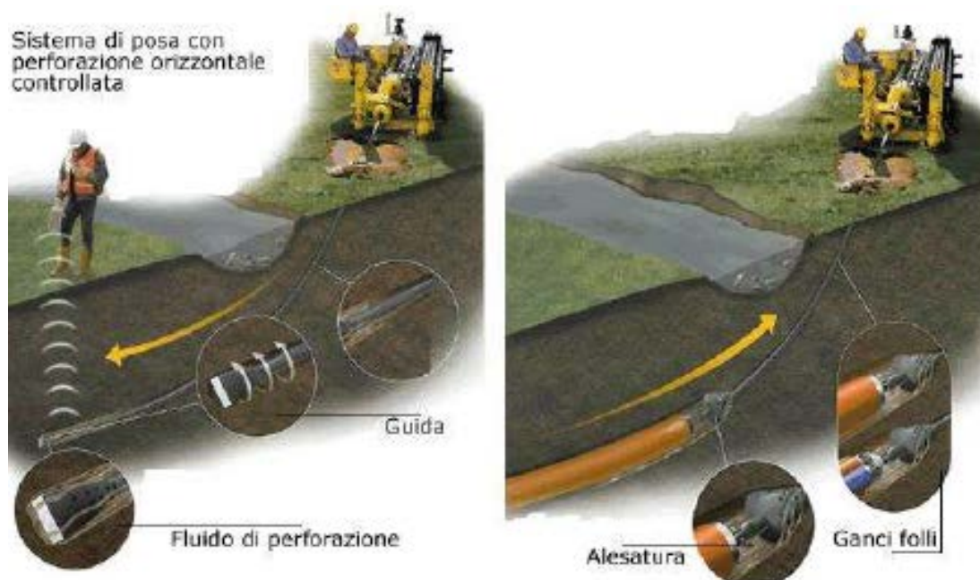
Posa in opera tubazione con trivellazione teleguidata
