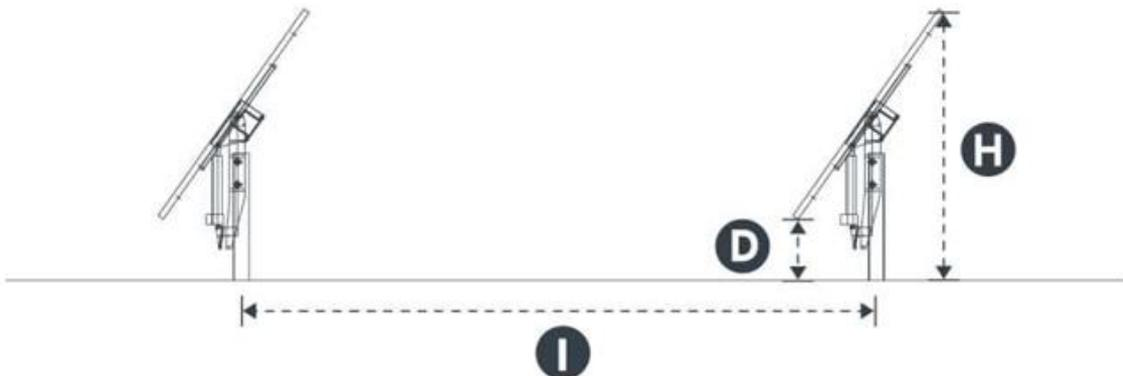
Figura 12 - Definizioni delle dimensioni ( $D = 0,80$  m,  $H = 2,77$  m,  $I = 4,38$  m)
