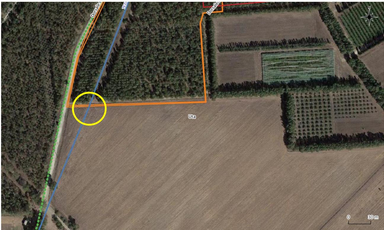
Figura 26 – Interferenza della Dorsali di progetto in verde con la condotta idrica Cixerri – Sud – Est (7E.C4) in blu, su OFC e catasto
