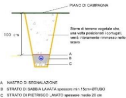
PARTICOLARE DELLA SEZIONE DI SCAVO DEI CAVIDOTTI
