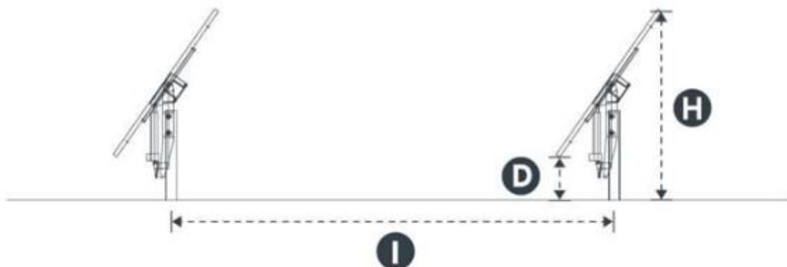
Figura 81 - Definizioni delle dimensioni (D = 0,80 m, H = 2,77 m, I = 4,38 m)
