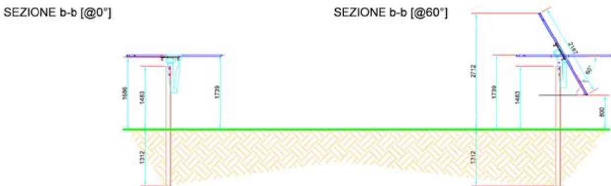
Figura 60 – Sezione tracker e moduli in progetto
