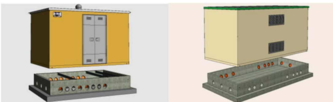
figura 7 – Tipico Cabina di Trasformazione prefabbricata monoblocco
