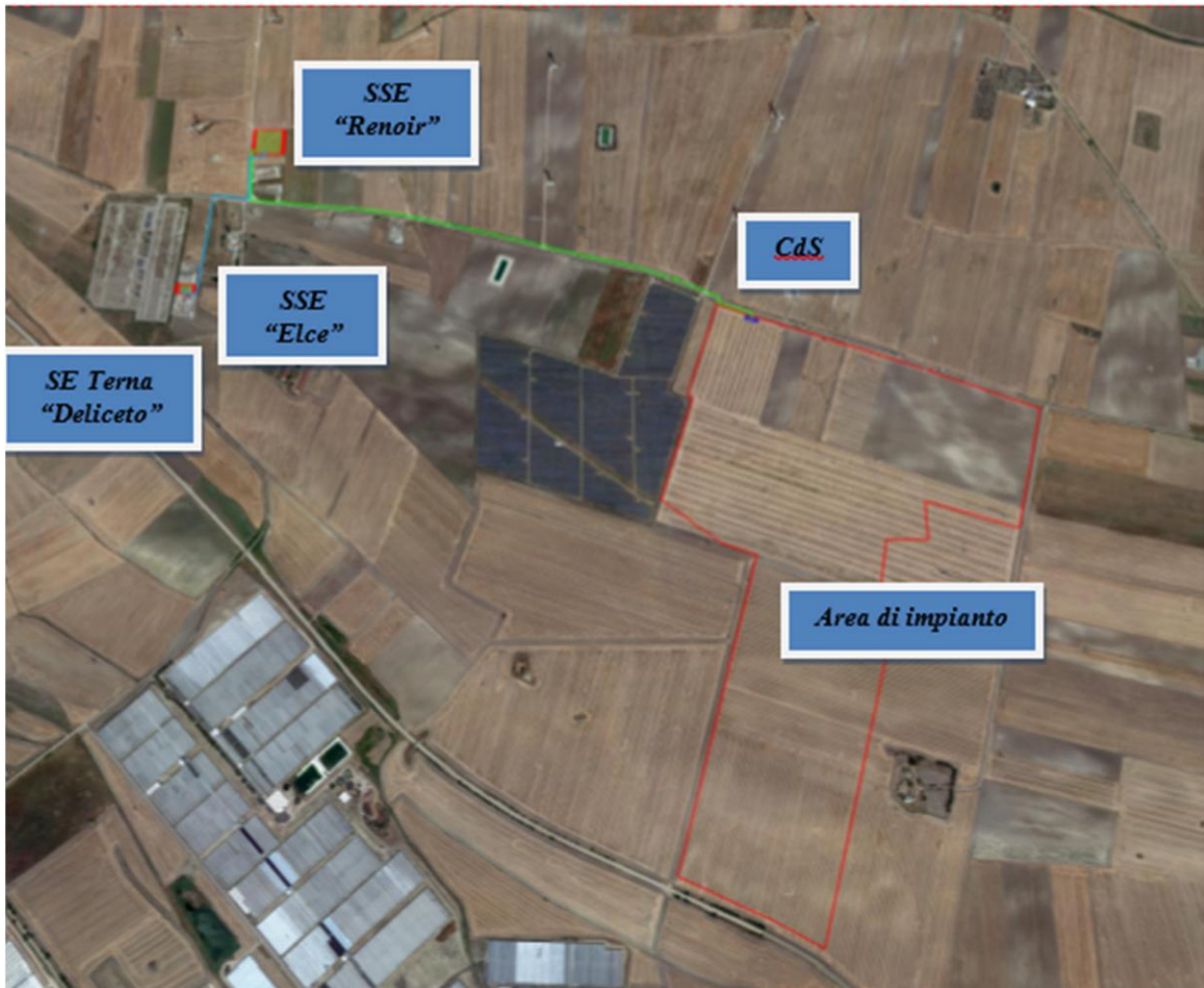
Inquadramento generale su Ortofoto – area impianto e SSE (in rosso), cavidotto MT esterno (in verde), cavidotto AT (in celeste)
