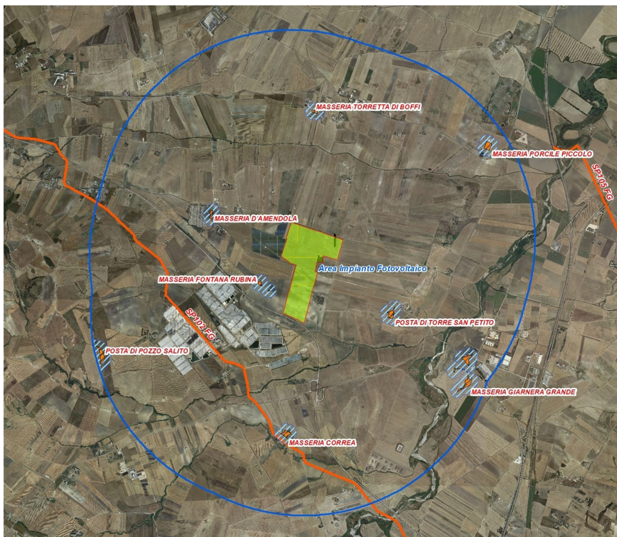
Componenti Culturali Insediative (Masserie) e Componenti Valori Percettivi (Strade a valenza Paesaggistica in arancione) nell'ambito dei 3 km dai confini di Impianto
